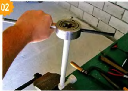
02 Для нарезки резьбы использовал обычную пилку.
