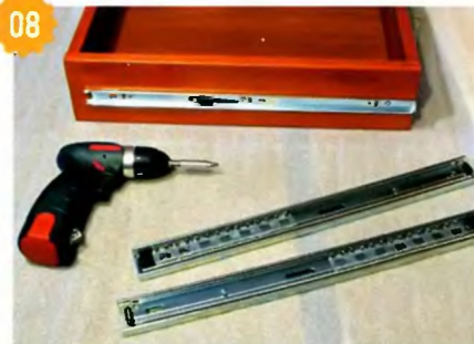
Установка частей шариковых направляющих на ящик тумбы.
