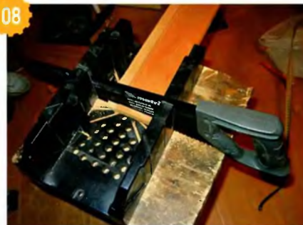
08 При распиливании вагонки использовали стусло.
