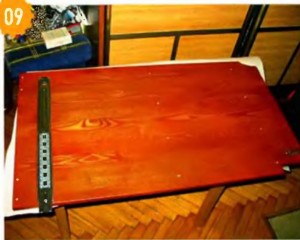
09 Вторая часть шариковых направляющих установлена на стойке.
