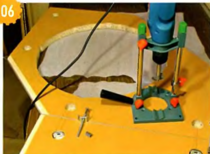
Части столешницы соединяются стяжками, под которые высверливались чашки Ø 35 мм.
