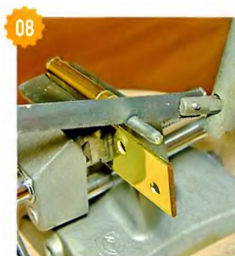
08 Чтобы облегчить установку дверного полотна, стержень у нижней петли можно немного укоротить.
