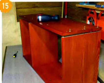
15 Сборка правой секции навесного шкафа на саморезы.
