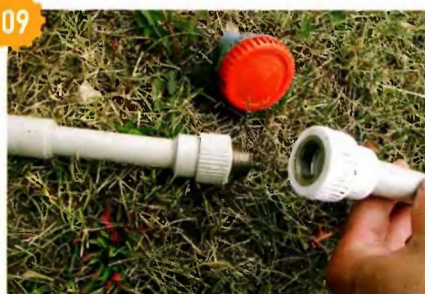
09 Чтобы подсоединить к насадке крюк, откручиваю душевую лейку и на её место вкручиваю крюк.
