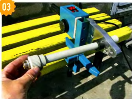
03 При сварке полипропиленовых труб получается прочное герметичное соединение.
